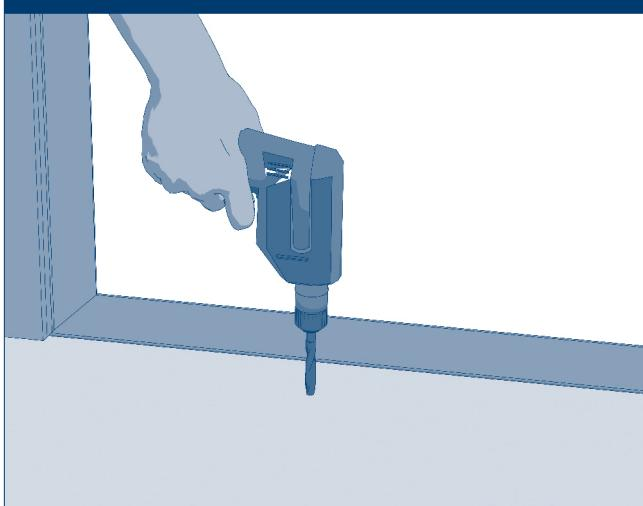
Просверлите отверстие глубиной 40 мм и диаметром 15 мм.
