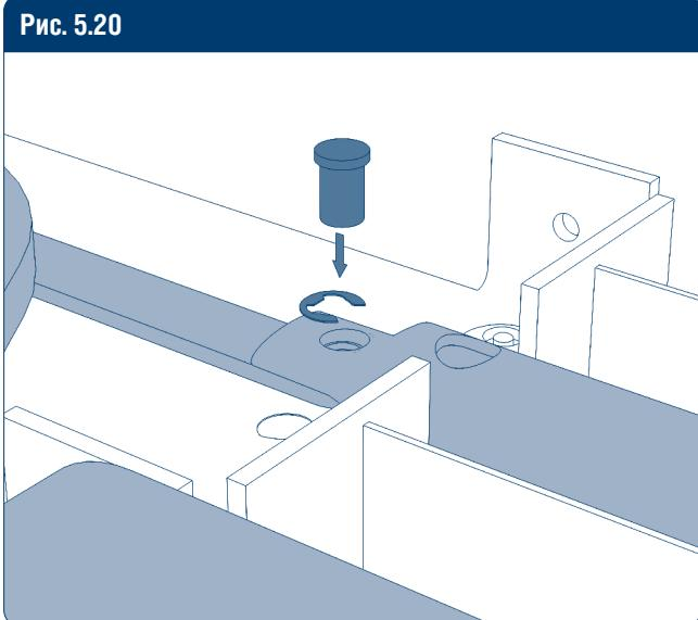
Закрепите ось тяги при помощи быстросъемного стопорного кольца.
