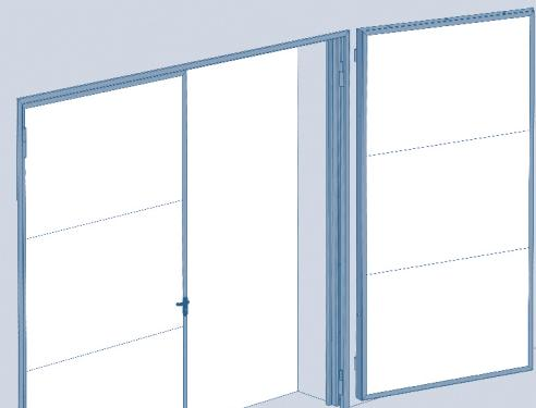
Навесьте створку в сборе с ригельной задвижкой на ось с полуупетлей вертикальной стойки. Зазор между створкой и полом должен составлять 20–25 мм, а при наличии щеточного уплотнителя – 45 мм.
