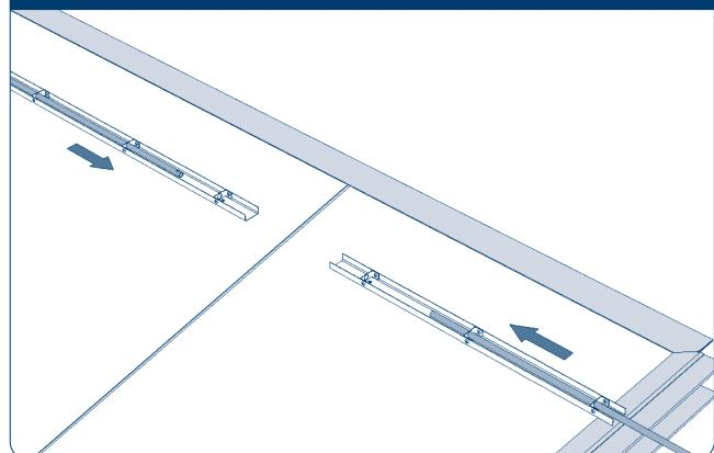
Для более надежного крепления короба к полотну ворот выполните дополнительные заклепочные соединения короба между установленными держателями, предварительно просверлив отверстия диаметром 4,2 мм. Затем поместите ригели в держатели.
