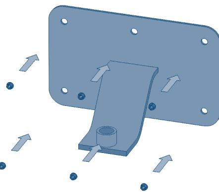
С помощью самокрутящихся гаек M8 выполните болтовое соединение пластины с кронштейном крепления привода.
