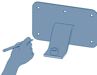
Отметьте места крепления кронштейна по специальным отверстиям.
