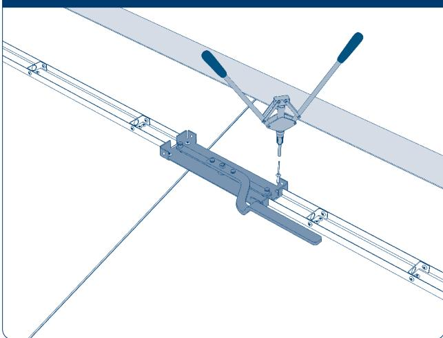
Используя заклепки D4,0 × L12 мм, закрепите механизм задвижки выполнив заклепочное соединение.
