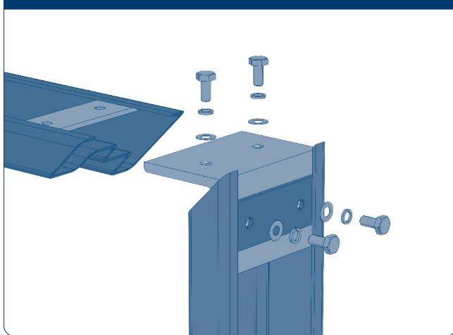
Соберите раму, соединив горизонтальную и вертикальные стойки через сухарное соединение с помощью болтов M 10 × 20 мм, шайб гроверных 10 мм и шайб 10 × 20 мм.
