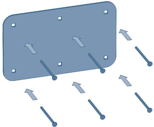
С обратной стороны с помощью болтов M 8 × 100 мм установите пластину под привод.
