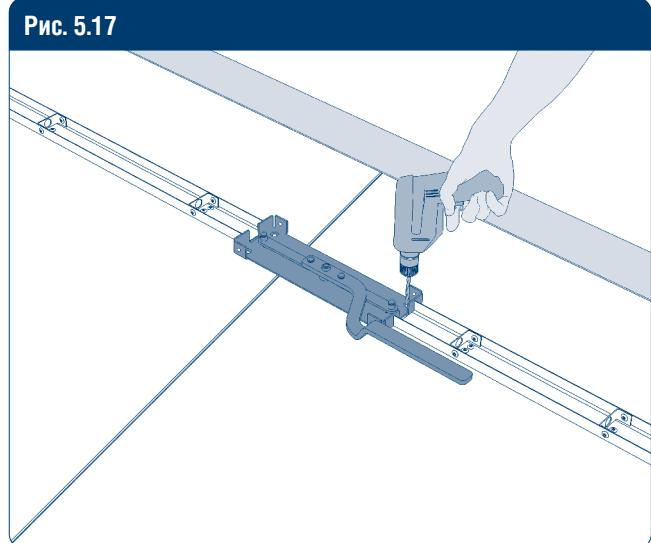
Установите механизм задвижки между коробами задвижки, затем просверлите шесть отверстий диаметром 4,2 мм для его крепления.
