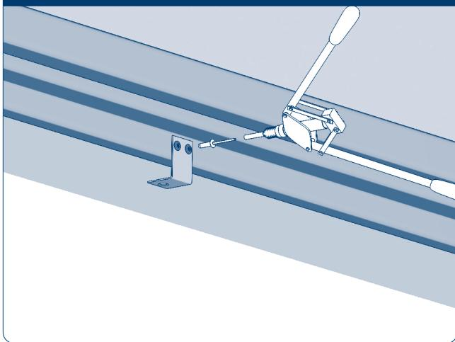
При монтаже ригельной задвижки с внутренней стороны ворот отметьте место крепления уха ригельной задвижки к горизонтальному профилю рамы и просверлите отверстие диаметром 4,2 мм.
