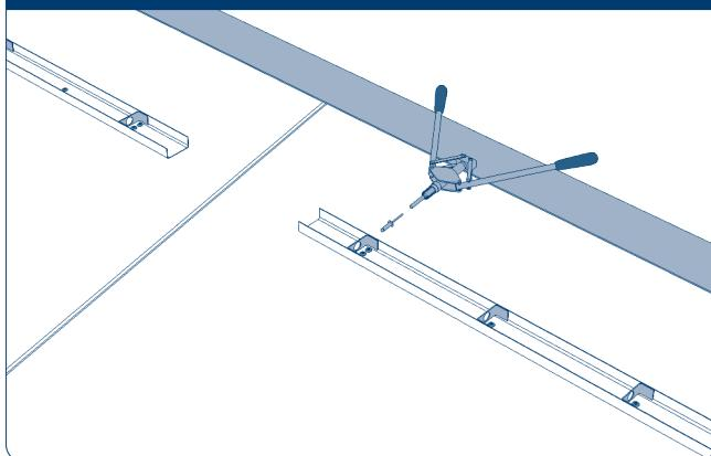
Используя заклепки D4,0 × L12 мм, выполните заклепочное соединение короба с держателями ригельной задвижки.
