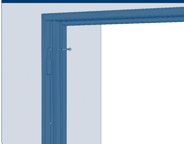
В зависимости от материала стен проема произведите крепление рамы либо с помощью анкерных болтов 12 × 150 мм, либо с помощью саморезов 6,3 × 70 мм по металлу/дереву. Установите съемные оси в полуопетки вертикальных стоек рамы. Наденьте опорные петлевые подшипники на оси.
