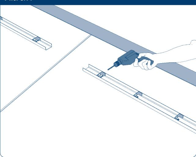
Используя заклепки D4,0 × L12 мм, выполните заклепочное соединение короба ригельной задвижки с полотном створки.
