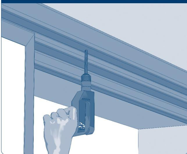
При монтаже ригельной задвижки с наружной стороны ворот отметьте место для ее фиксации в горизонтальном профиле и просверлите отверстие диаметром 15 мм.
