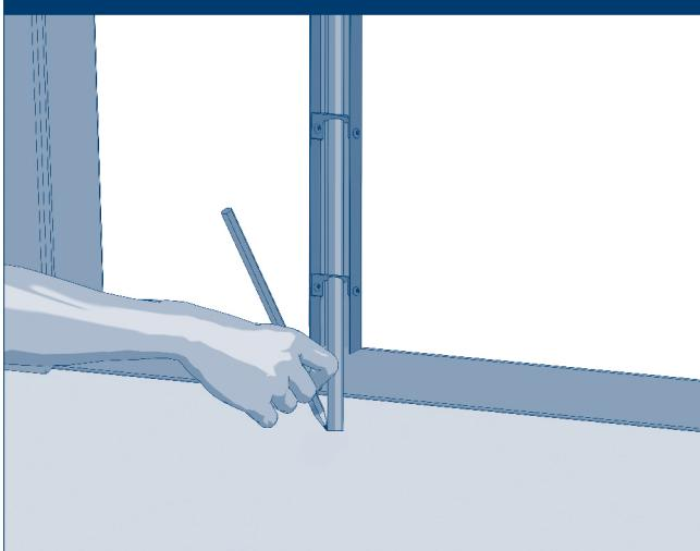
Отметьте место фиксации ригельной задвижки в полу.
