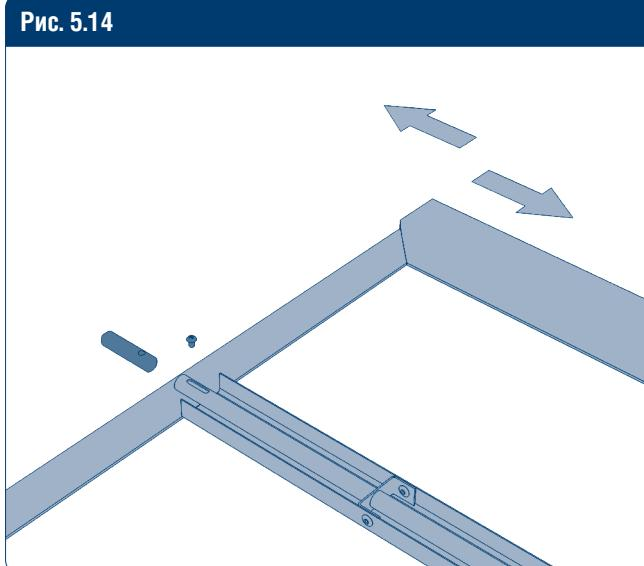
В верхней части полотна в зависимости от типа монтажа ригельной задвижки установите фигурный (задвижка внутри) или прямой (задвижка снаружи) стальной палец.
