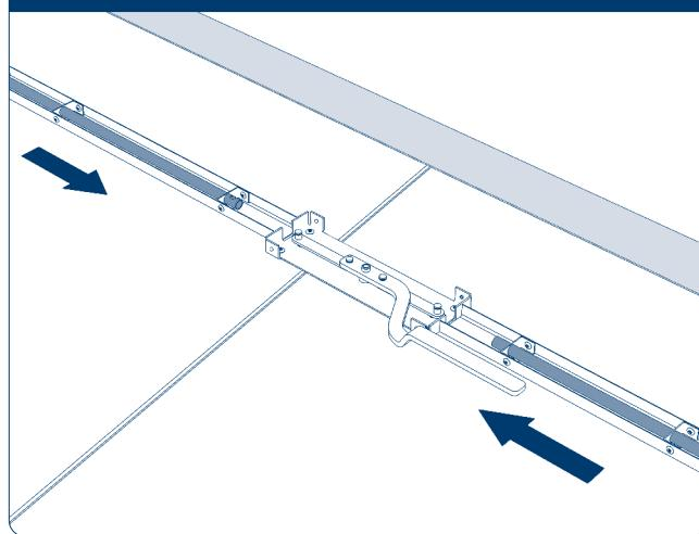
Зафиксируйте ригели с помощью оси тяги механизма задвижки.
