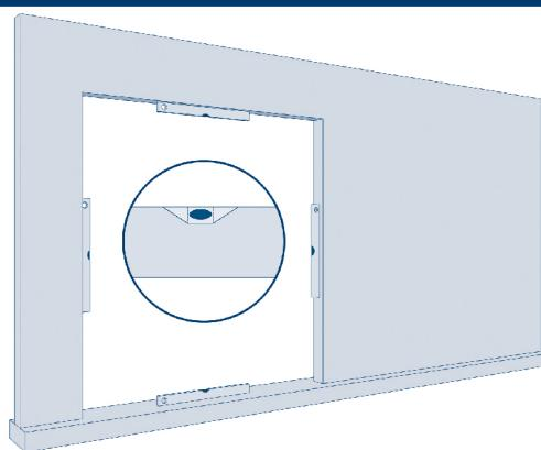
Для обеспечения правильного монтажа внутренняя поверхность проема должна быть ровной и гладкой. Перепад уровня по всему периметру проема должен составлять не более 1 см. Монтаж следует проводить так, чтобы от пола до нижнего края полотна ворот оставалось 20–25 мм, а при наличии щеточного уплотнителя – 45 мм.
