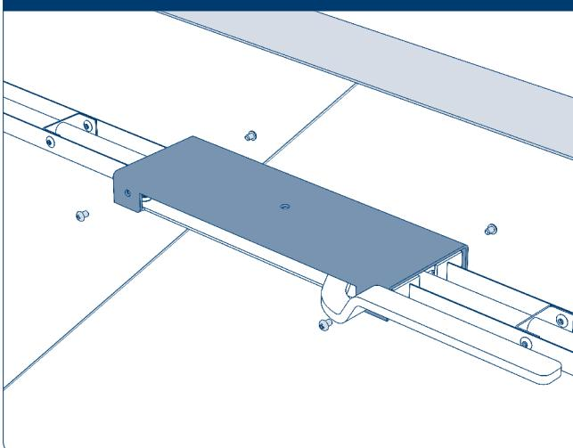
Закрепите ее при помощи четырех винтов M 4 × 8 мм.
