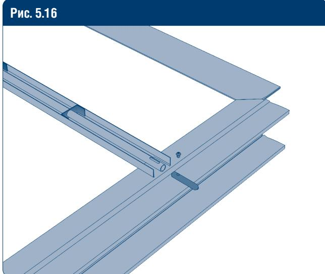
Снизу полотна установите обычный стальной палец. Зафиксируйте их при помощи винтов M 4 × 8 мм.
