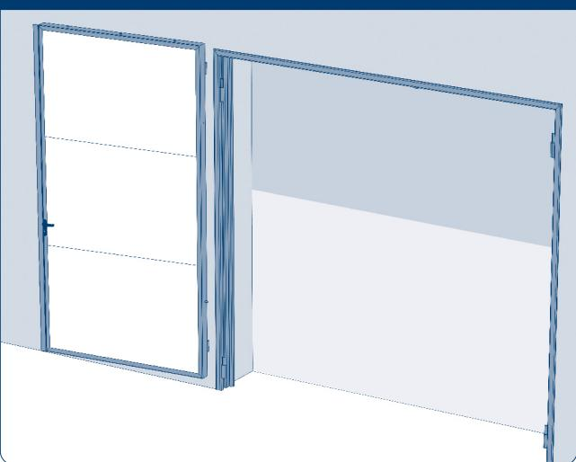
Навесьте створку в сборе с замком на ось с полуупетлей вертикальной стойки. Зафиксируйте винт установочный. Перед тем как повесить вторую створку, необходимо установить ригельную задвижку. Ригельная задвижка может быть установлена двумя способами: с наружной или с внутренней стороны ворот. Расстояние от верхней части механизма задвижки до нижней части полотна – 1 200 мм.
