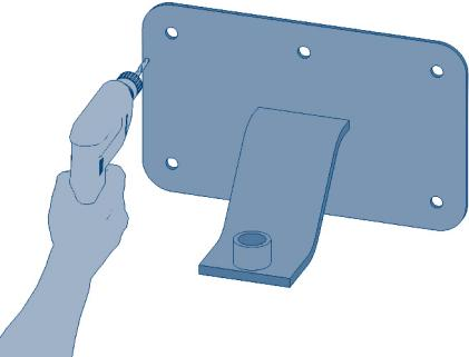
По отметкам в полотне просверлите сквозные отверстия под прямым углом диаметром 9 мм.
